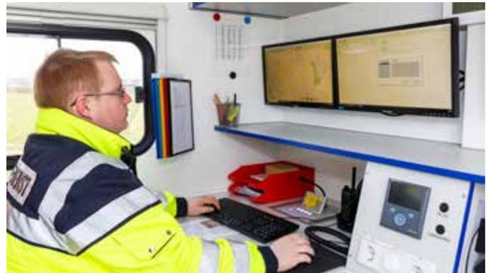
In der Funkkabine (befindet sich im vorderen Teil des Fahrzeugs) zeigt Gruppenführer Matthias Maage den vier Quadratmeter großen Arbeitsbereich der Sprechfunker. Dieser ist mit modernster Kommunikationstechnik ausgestattet, beinhaltet unter anderem vier Monitore, drei Digitalfunk- und ein analoges Funkgerät, Fax und Internetanschluss.
